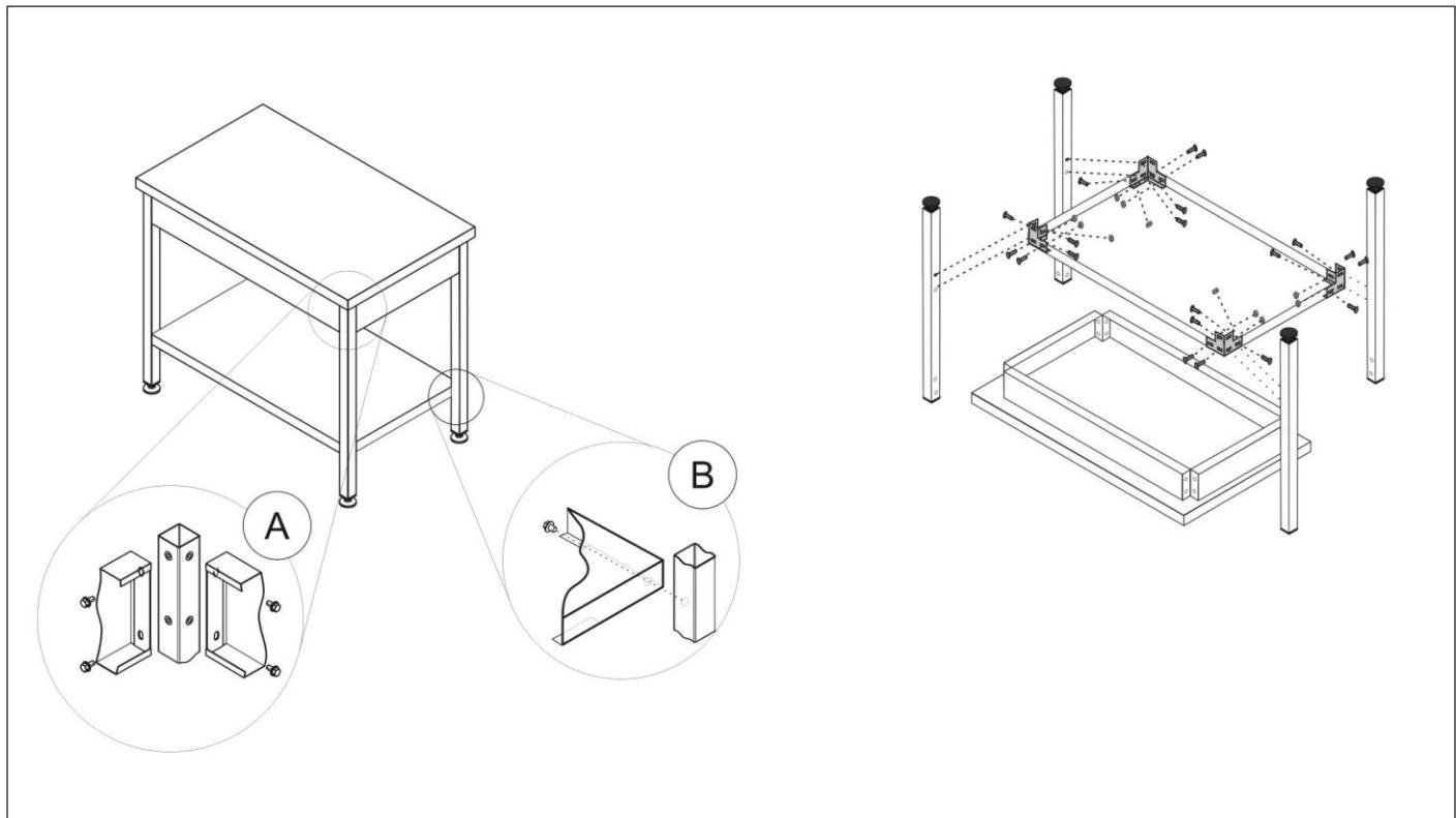
1 Столешницу (1) перевернуть и разместить на ровной и чистой поверхности, стойки (2) прикрепить к столешнице с помощью 4-х винтов М6 (4) в каждом углу стола (как показано на рис. А)
