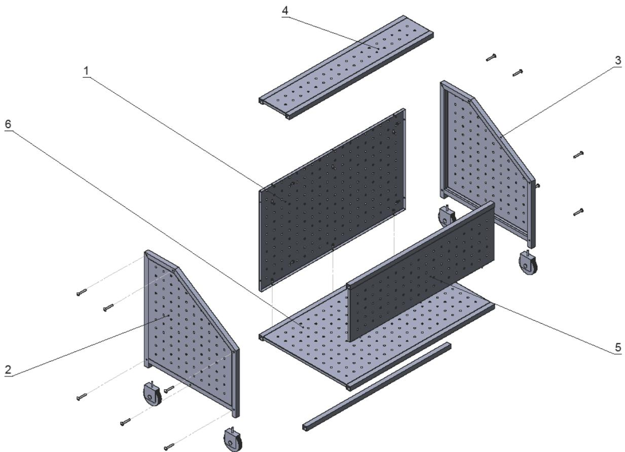
**Рисунок 1** Схема сборки разборного мобильного ларя
