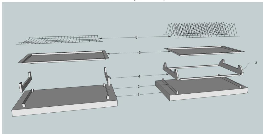
**Рис.5** Схема сборки полки стеллажа, для сушки посуды(тарелок, стаканов)
