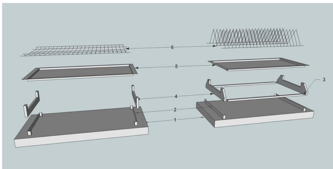
**Рис. 1** Схема сборки полки ПКс, ПКт, для сушки посуды (тарелок, стаканов)
