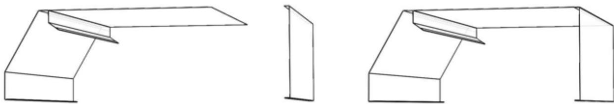
3) Закрепить боковины с передней панелью, крышей и задней стенкой при помощи болтов M5.
