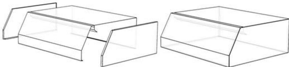
4) Закрепить кронштейны по углам к задней и передней панели.
