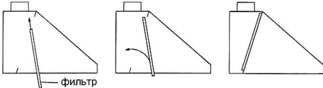
Рекомендуется промывать зонт 1 раз в день щёткой-ершиком под тёплой проточной водой (предварительно отключив от электросети – в моделях, оснащенных подсветкой и вентилятором).
